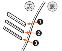
1. 本体表側から、肩ベルトの先端を①ベルト通しに通して裏側に入れる。ベルト先端を③ベルト通しから表側に出し、②ベルト通しに通して裏側に入れる。
