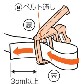
腰ベルトの長さは、ベルトの端が3cm以上残るように調節してください。
