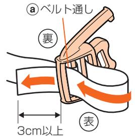
バックル表側に出ている腰ベルト先端は、3cm以上の長さを残してください。
