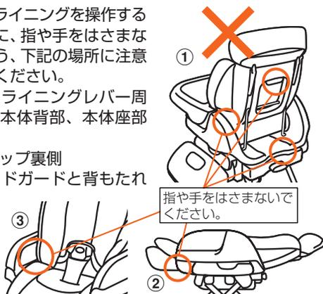
●スウィングする場合、製品背面の本体座部と裏面カバーの間、サイドガードとサイドカバーの間、ステップ裏側のすき間に指や手をはさまないように注意してください。
