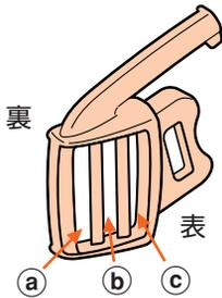
1. 腰ベルトの先端を①ベルト通しからはずし、①調節したい分の長さを引き出す。
