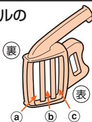
1. バックル裏側から、腰ベルトを①ベルト通しを通して、表側へ引き出す。
