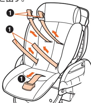
②本体中央部のフック2カ所とフック付ベルトを本体両側面の丸穴(2カ所)に座面の外側から内側に通し引き出して、ベルトのフックとシート端のフックをとめ、
