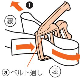
2. 腰ベルトを左右に引っ張り、ベルトの長さを調節する。長くするには、②の方向に引っ張り、短くするには、③の方向へベルトの先端を引っ張る。
