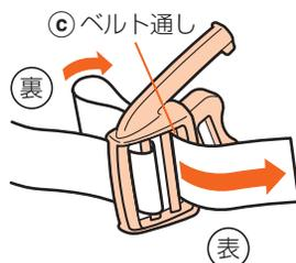
4. ベルト先端を④ベルト通しを通して、裏側へ入れる。
