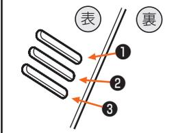
※肩ベルトの表裏を確認してください。縫い目の折り返しがある面が裏です。先端の折り込まれている面に注意して、取り付けてください。
