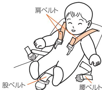
3. 股バックルを引き出し、股バックルの左右に重ねた肩と腰バックルを差し込み、「カチッ」と音を確認することを確認する。
