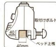
②本体がベッドの上桿に水平になるように取付け、取付けボルトをしっかりと締めつけます。
