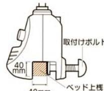
このメリーは上桿の形状が角形で、高さ40mm以上厚さ40mm以下のベビーベッドのみ、取付けることができます。ベビーベッドに取付けるさい必ず事前にベビーベッドの寸法をご確認ください。
