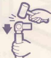
**3** 左右のジョイントは、床の平面を利用して互いに向きを合わせ正しく接続してください。無理にねじったり曲げたりしないでください。ゆがんだ場合は、一度引き抜いてから再度押し込んでください。
