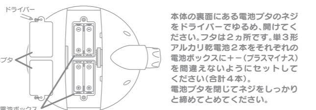
本体の裏面にある電池ブタのネジをドライバーでゆるめ、開けてください。フタは2カ所です。単3形アルカリ乾電池2本をそれぞれの電池ボックスに+(プラスマイナス)を間違えないようにセットしてください(合計4本)。電池ブタを閉じてネジをしっかりと締めてとめてください。
