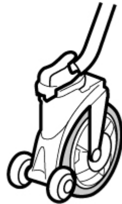
「コンビキャリー スルーン」の 特徴：前輪に小さな補助車輪付き
