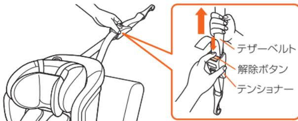
7 トップテザーアンカーにトップテザーフックを固定する。
